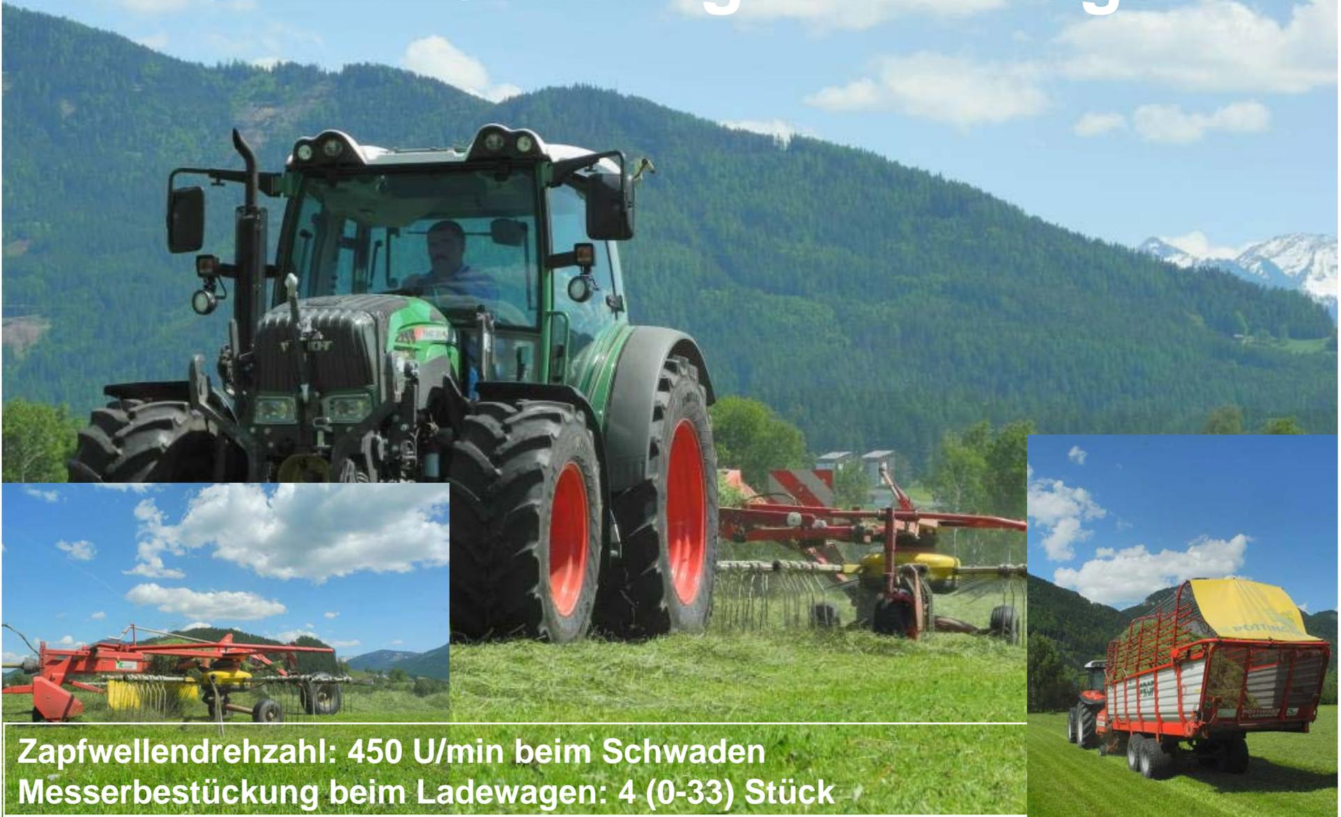
Zapfwelldrehzahl: 450 U/min beim Schwaden
