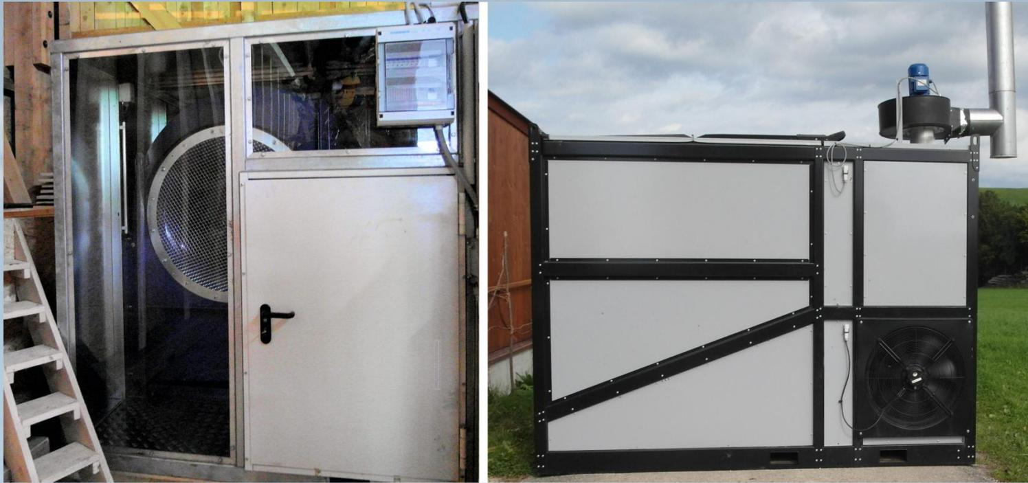
Eine wünschenswerte kurze Trocknungszeit um 30 bis 60 Stunden ist in der Regel nur in Verbindung mit einer Anwärmung oder Entfeuchtung der Trocknungsluft erreichbar!
