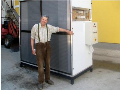
Als Alternative zur Luftanwärmung empfiehlt sich die Luftentfeuchtung durch einen geringeren Energiebedarf. Nachteilig ist allerdings ein höherer elektrischer Anschlusswert.
