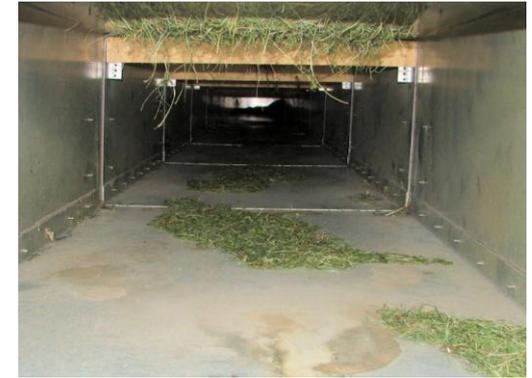
**Konisch sich verjüngende Luftkanäle unterhalb von Ballenlöchern bringen eine ideale Druckverteilung.** Ein gleichbleibender Kanalquerschnitt ist jedoch bei einer Luftgeschwindigkeit am Kanaleingang unterhalb von 8 bis 10 m/s vertretbar. Bei höheren Luftgeschwindigkeiten können Bremsleisten oder Lochbleche einen Druckausgleich herstellen.
