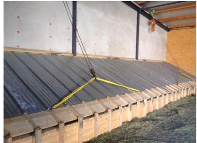
kombinierte Ballen-/Hackgutbelüftung, rechts abgeklappter Schrägrost
