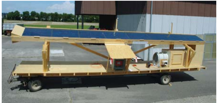
Abb. 3: Die Versuchsanlage (PV-Anlage) der ART besteht aus acht Photovoltaikmodulen im Dach integriert (20°). Ein Ventilator (unten rechts) mit vorgeschaltetem Messventilator erlaubt eine stufenlose Luftgeschwindigkeitsregelung zwischen 1 und 7 m/s.
