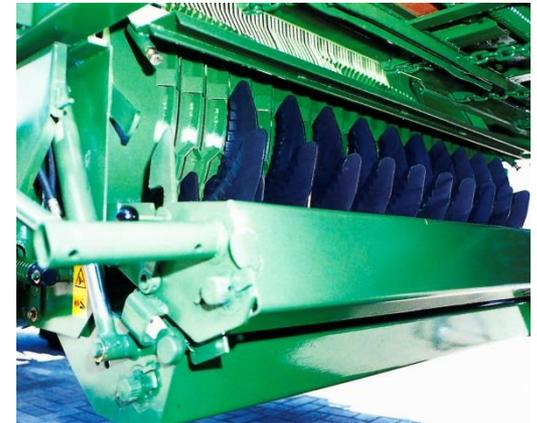
Kurzes Futter lässt sich besser verdichten – Ausrüstung mit Schneidmessern bis 4 cm Messerabstand → Silage
