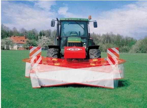
Frontmäherwerk mit Pendelanhängung
