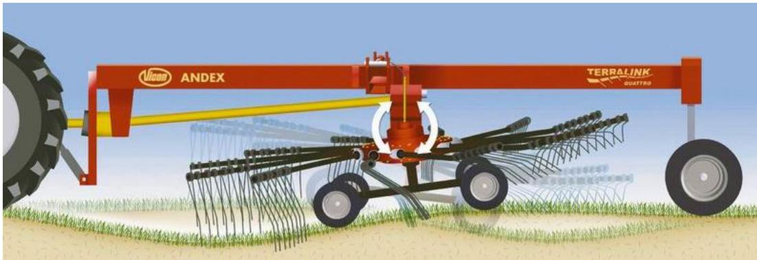
Doppelachse mit pendelndem Schwadaggregat
