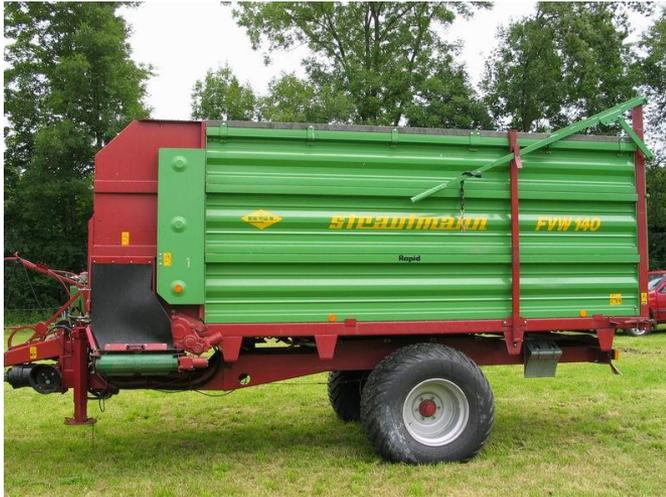
Silierwagen besitzt kein Pick-up, sondern nur Kratzboden und Dosiereinrichtung.
