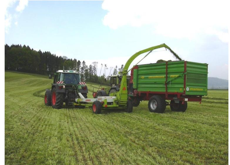
Befüllung mittels Häcksler
