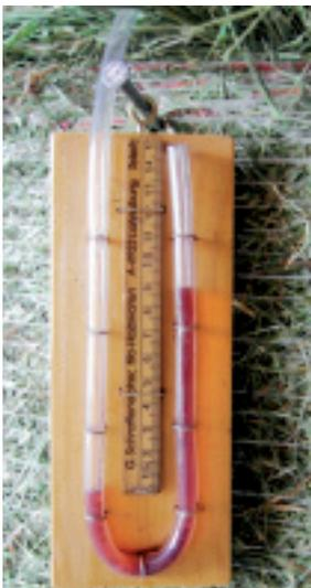
Um den statischen Druck zu messen wird ein Schlauchende unterhalb des Boxenrostes oder in den Speisekanal einer Ballentrocknung verlegt. 1 mm Wassersäule entspricht dabei ca. 10 Pa.
